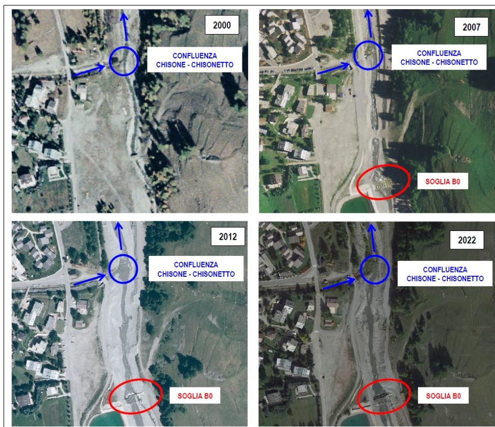
Figura 1.15: Sequenza storica di foto aeree del tratto di torrente Chisone compreso tra la soglia B0, realizzata presso l'invaso per l'innevamento artificiale in Località Pattemouche, e la confluenza con il torrente Chisonetto
